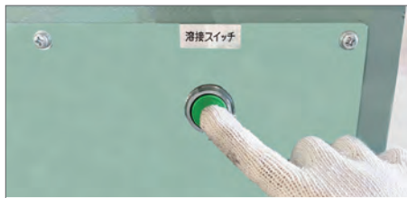
⑤溶接スイッチを押す
